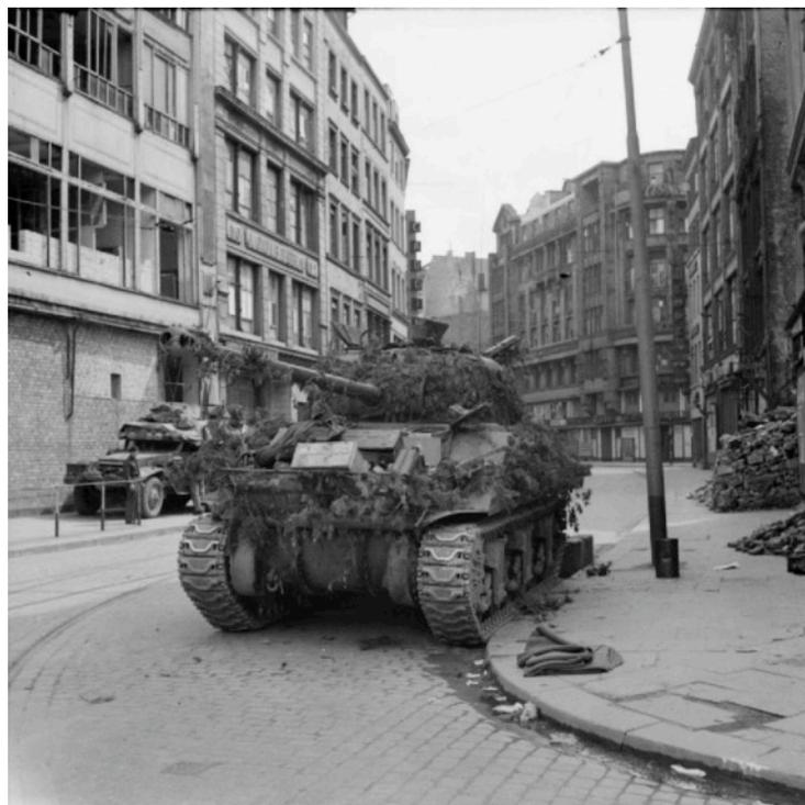
Armement : principal. Un canon de 17 pounder soit 76,2 mm QF (Quick Firing) Mk IV L55 ; dotation 77 projectiles. Secondaire une mitrailleuse M1919A4 de 7,92mm. Dotation 5000 projectiles. Une mitrailleuse M2 Browning de 12,7mm. Dotation 1170 projectiles.
