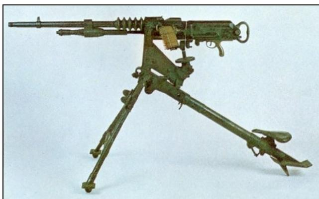
Mitrailleuse Hotchkiss (avec bande rigide en place)
